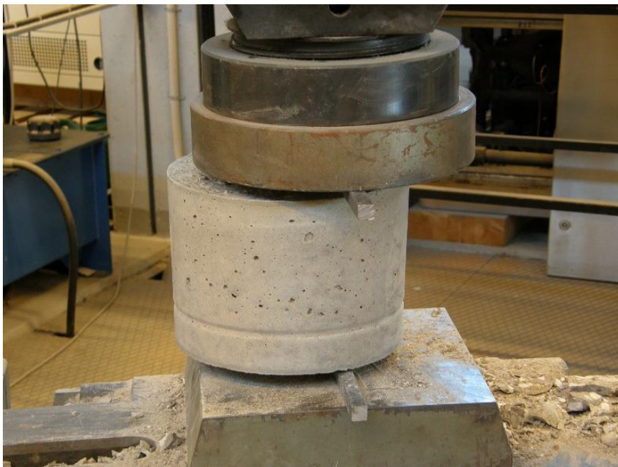
Figur 2.5 Hydraulisk press för spräckning av prov som demonterats ur form.
