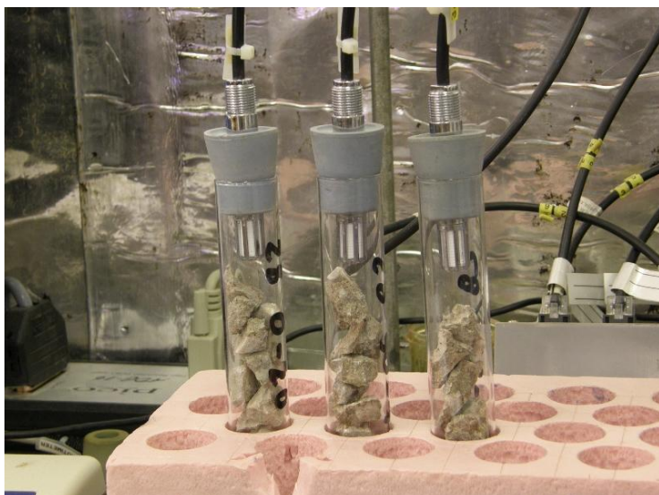
Figur 2.9 Mätning av relativ fuktighet på uttagna prov placerade i provrör med givare av fabrikat Vaisala.
