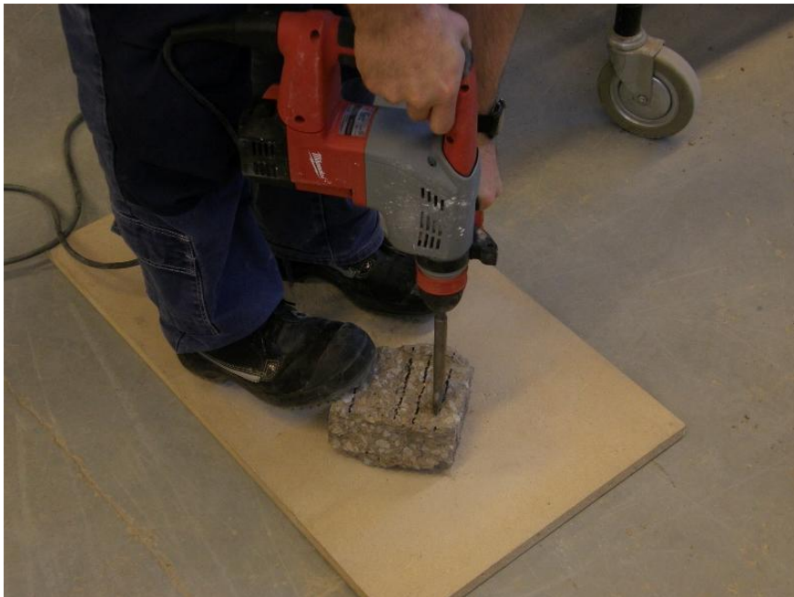
Figur 2.7 Från rätblock enligt figur 2.6 tas prov ut från tre djup, 0-20 mm, 50-70 mm och 130-150 mm, med hjälp av bilningsmaskin.
