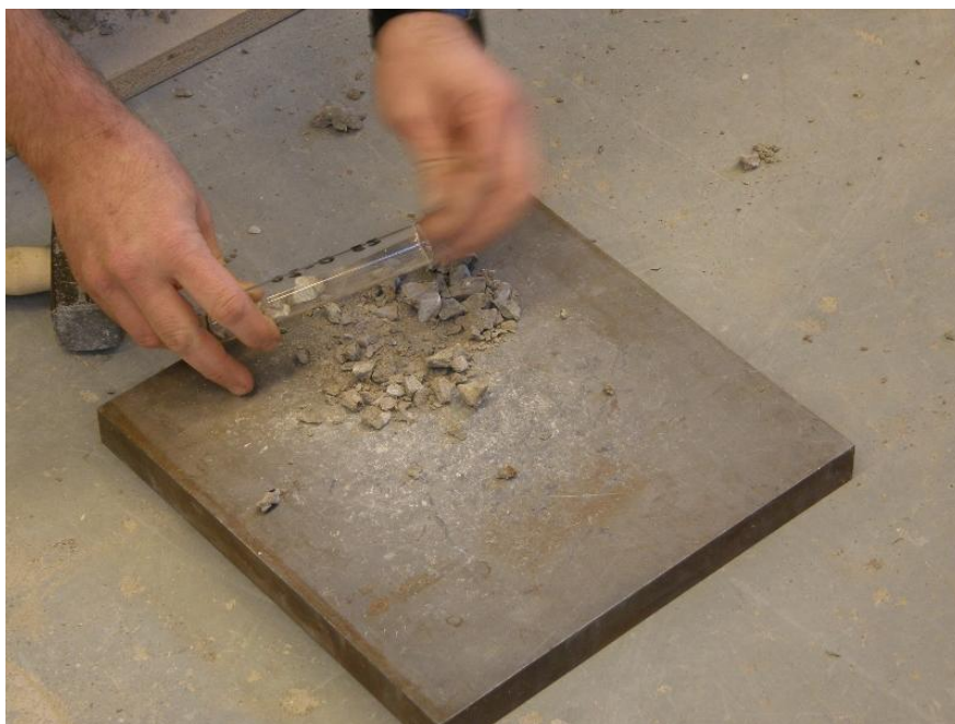
Figur 2.8 Uttagna provbitar från respektive djup placeras i glasrör som förseglas med gummikork i väntan på RF-mätning.
